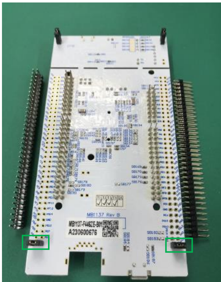
図 6-1 NUCLEO-F446ZE CN11・CN12 未実装状態
