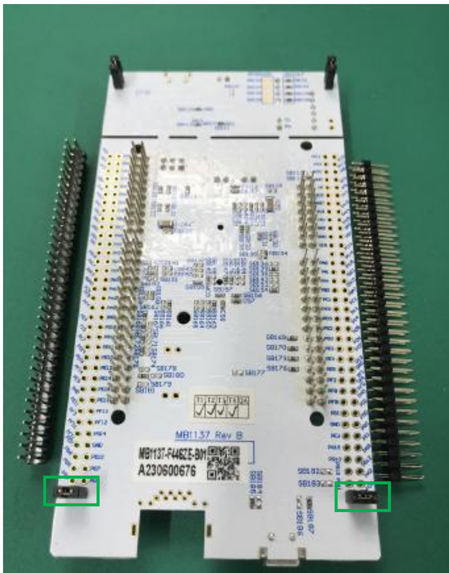
図 6-1 NUCLEO-F446ZE CN11・CN12 未実装状態
