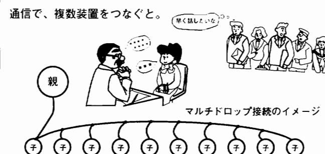
ポーリング方式によるマルチドロップ接続では、親機から順次子機との対話を指定していくので、全体の応答速度が遅くなり、指名する制御などの余分なコントロールも必要となる。
