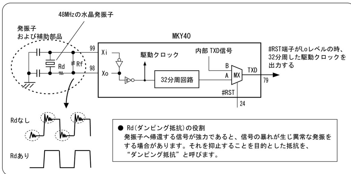
図3.1 駆動クロックの自己生成
