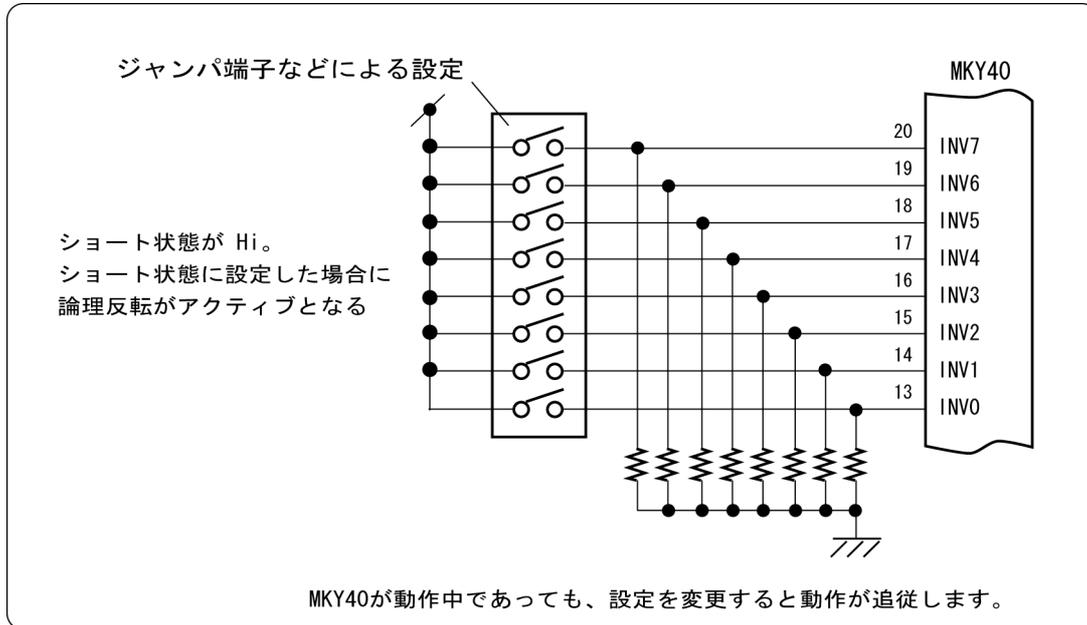
図7.7 汎用入出力外部端子の論理設定例
