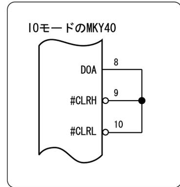
図7.9 ウォッチドッグ出力のクリア例
