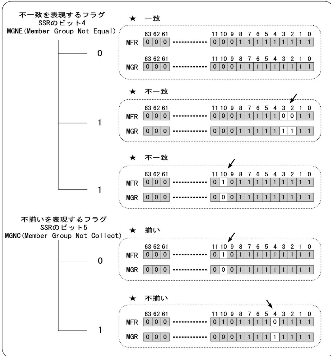
図4.16 MGRによるMFRの監視とSSRのビット状態
